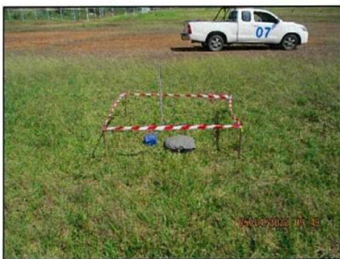
ภาพถ่ายที่ 3.4.3-1 การตรวจวัดแรงสั่นสะเทือน โครงการพัฒนาสนามบินตราด ระหว่างวันที่ 5-7 เมษายน 2565
