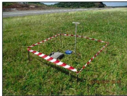
ภาพถ่ายที่ 3.4.3-1 การตรวจวัดแรงสั่นสะเทือน โครงการพัฒนาสนามบินตราด ระหว่างวันที่ 5-7 เมษายน 2565
